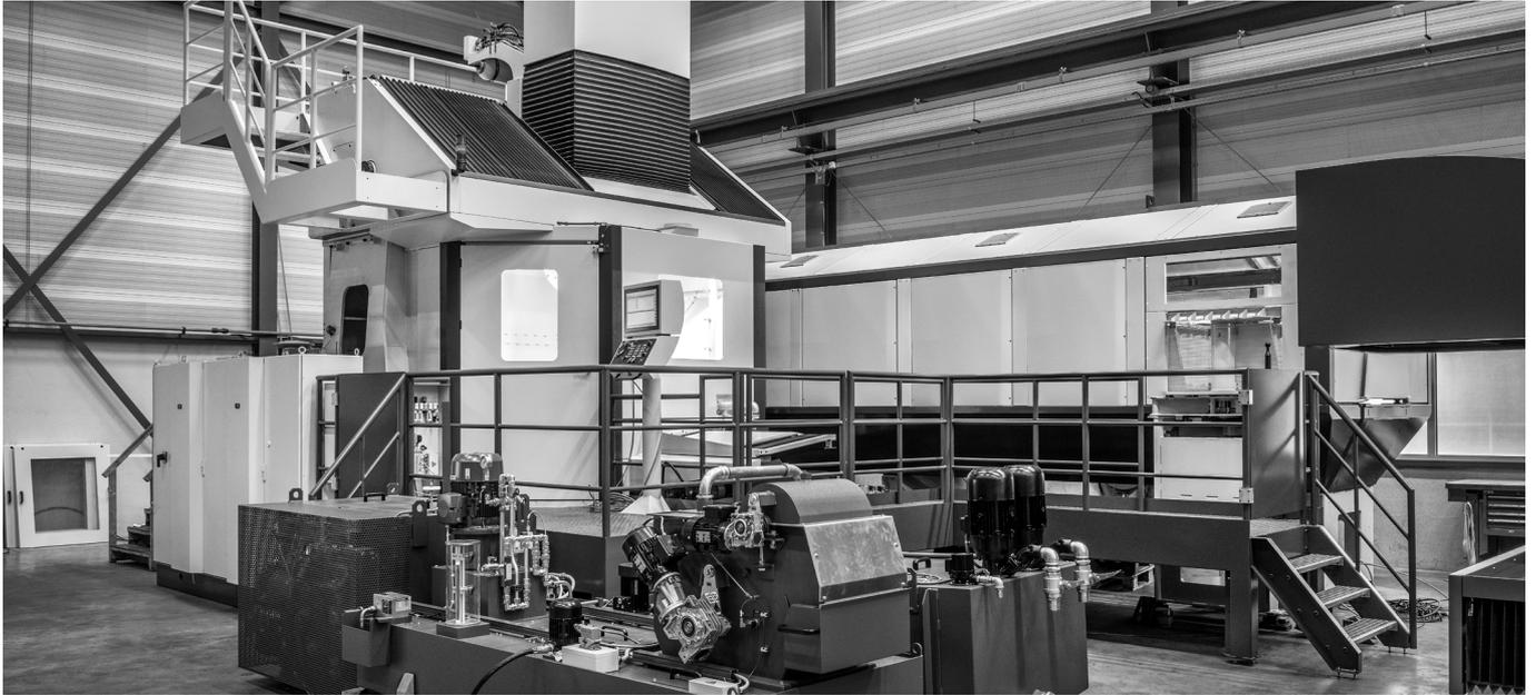
该系统由两台连接到具 32 个托盘空间的传送带的机器组成，这在当时是人们眼中的“最新技术”。20 年过去了，现必须开发一种概念，以使用有效的系统替换老化机器或对其进行翻新改造。其框架条件是用于现有零部件组合的约 1000 个 NC 程序都可以继续在新机器上使用。”
